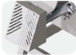
5. Protezione bocca per piastra con foro \varnothing > 8 mm Safety device for \varnothing > 8 mm plates.
