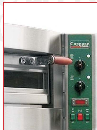
È il sistema di comando tradizionale, costituito da un termostato digitale che controlla la temperatura della camera e da due commutatori a tre posizioni (spento, minimo, massimo) che controllano separatamente il gruppo di resistenze del cielo e della platea.
